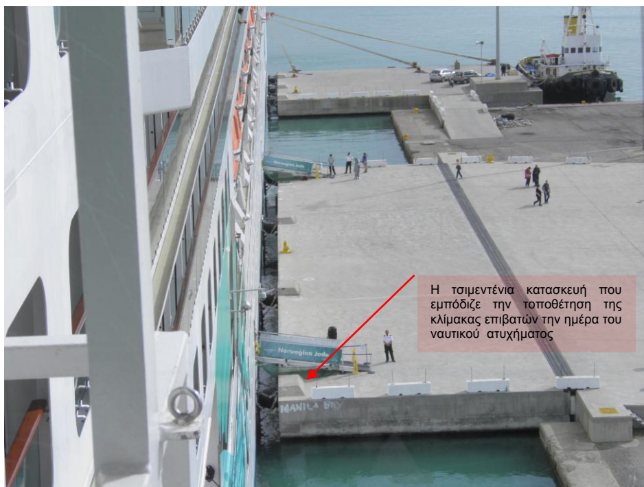
Εικόνα 4. Το Norwegian Jade πλαγιοδετημένο στον λιμένα Κατακόλου. Η διάταξη των κλιμάκων επιβατών.
