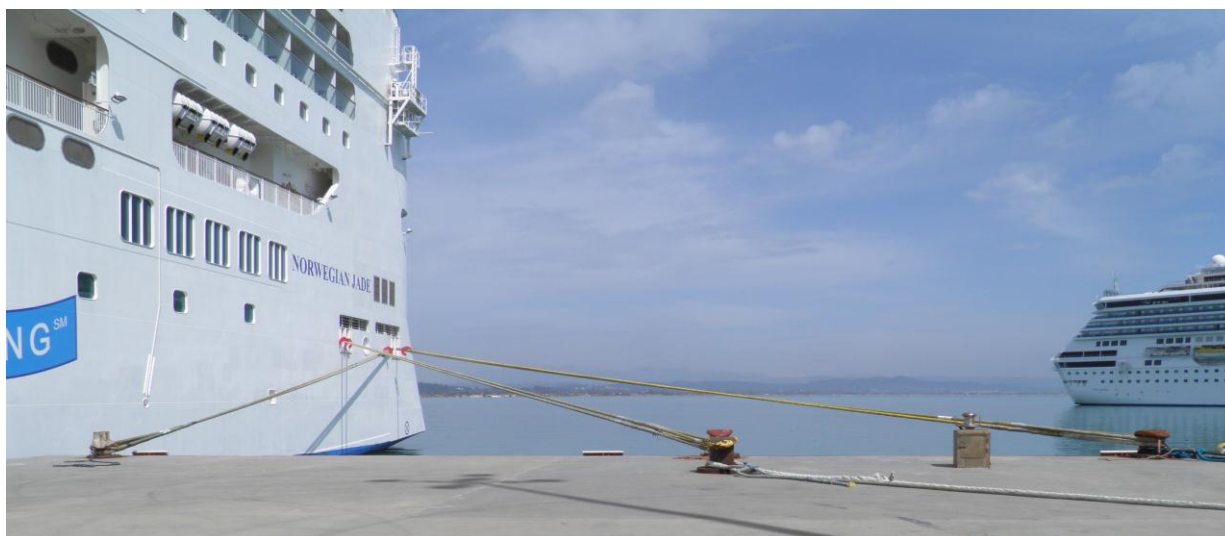
Εικόνα 24. Διάταξη πρυμναίων κάβων
