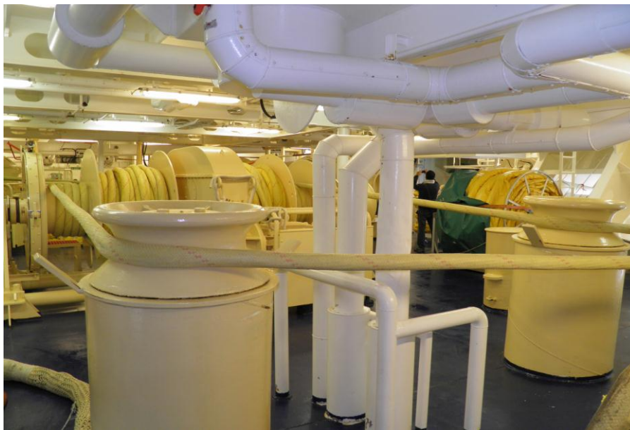
Εικόνα 27. Το πρωραίο βαρούλκο και η διάταξη των κάβων όπως φαίνονται από την πλώρη του πλοίου
