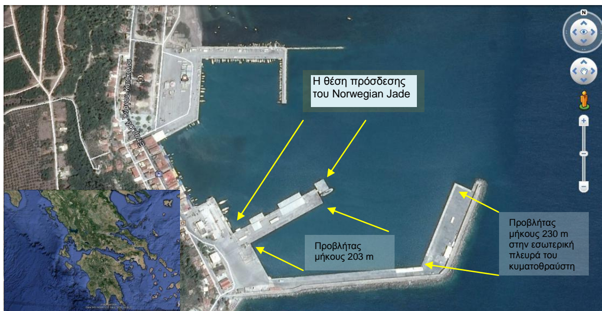
Εικόνα 10.Γενική διάταξη του λιμένα Κατακόλου. Πηγή: Google Earth
