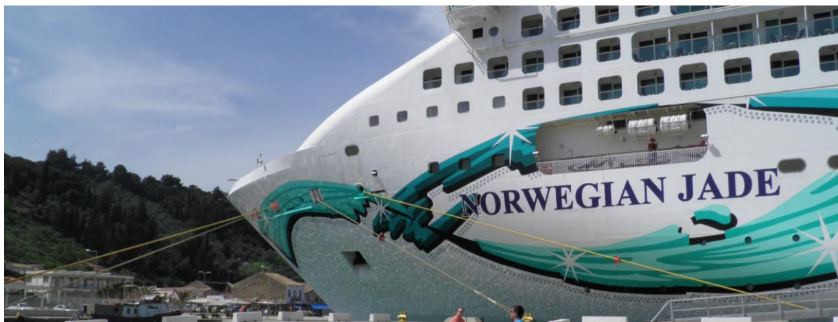
Εικόνα 23. Διάταξη πρωραίων κάβων
