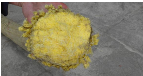
Εικόνα 19. Τομή του κάβου πλησίον του σημείου θραύσης
