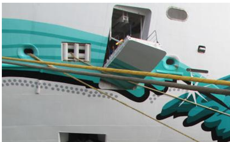
Εικόνα 6. Η παραμορφωμένη πλατφόρμα πρόσδεσης μετά το ναυτικό ατύχημα.
