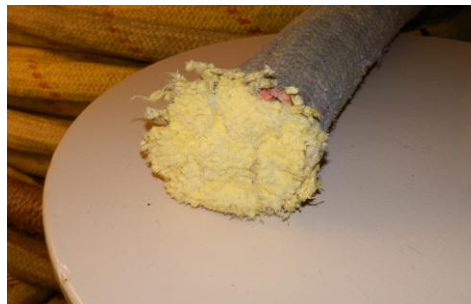
Εικόνα 20. Τομή από το κομμάτι του κάβου το οποίο παρέμεινε στο πλοίο
