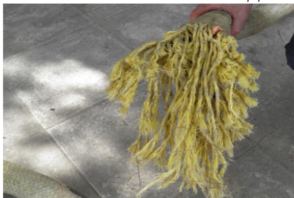
Εικόνα 21. Ο Νο 2 πρωραίος πλαγιοδέτης στο σημείο θραύσης
