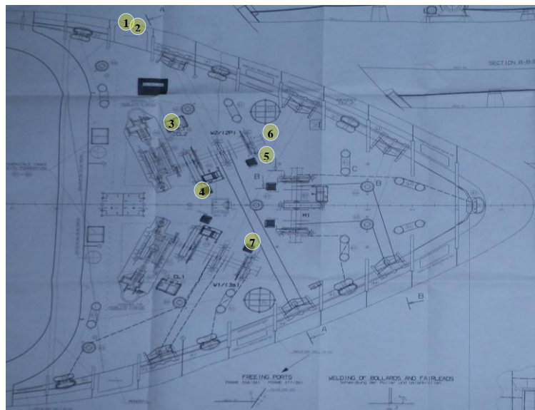
Εικόνα 28: Το πρωραίο κατάστρωμα πρόσδεσης του Norwegian Jade με τις θέσεις του πληρώματος κατά τη στιγμή του ναυτικού ατυχήματος
